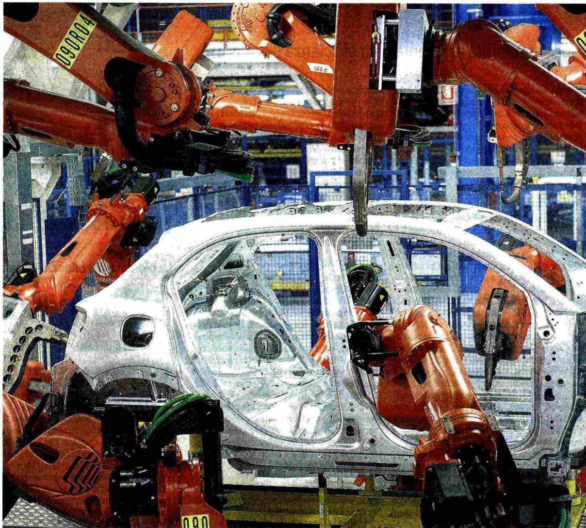
**A Melfi.** Nella foto la scocca di una Fiat 500X che viene assemblata nel reparto lastratura dello stabilimento Fca di Melfi. In questa area della fabbrica lavorano 860 robot (molti dei quali Comau) che rendono solidali tutte le parti di lamiera con diversi sistemi di giunzione
