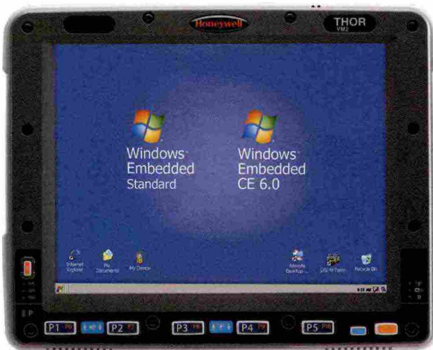
Thor VM2, computer veicolare Honeywell, dotato di schermo XGA da 9,7 pollici.
