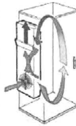
Applicazione con scambiatore di calore aria/aria
