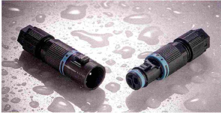
Connettore presa-spina rubacorrente IP68. Il connettore presa-spina TH370 a perforazione di isolante Techno è un prodotto che permette di prelevare corrente in modo rapido e in assoluta sicurezza. La soluzione è particolarmente adatta nell'illuminazione decorativa, luminarie e festoni, ideale in termini di qualità e affidabilità. I tempi di installazione risultano notevolmente ridotti e la sicurezza dell'impianto garantita dal grado di protezione IP68 (massima protezione da polveri e acqua).
