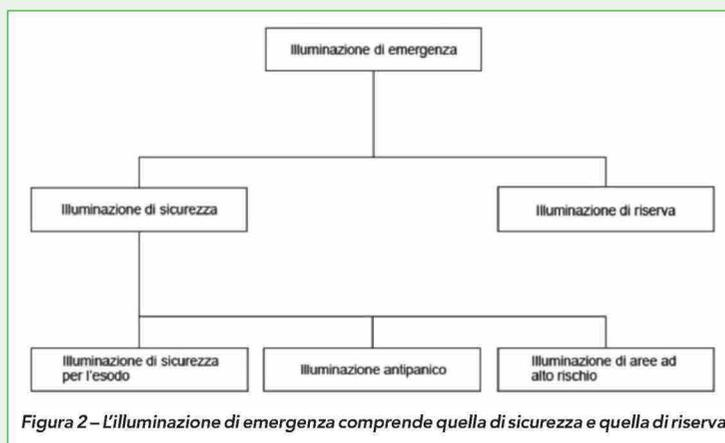
Figura 2 – L'illuminazione di emergenza comprende quella di sicurezza e quella di riserva
