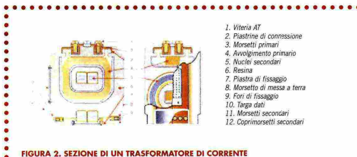
FIGURA 2. SEZIONE DI UN TRASFORMATORE DI CORRENTE
