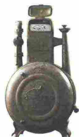
Contatore del gas ad acqua 5 becchi, 1914
