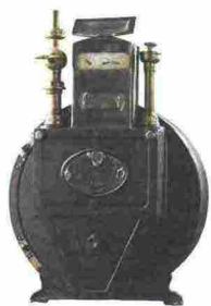
Contatore del gas ad acqua 5 becchi con particolari in bronzo, 1900
