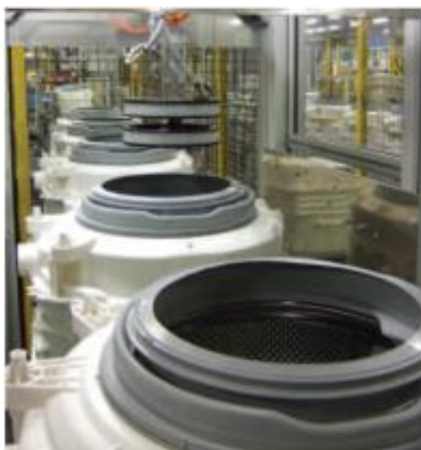
Stazione per il controllo della distanza tra il cestello e la guarnizione della vasca
