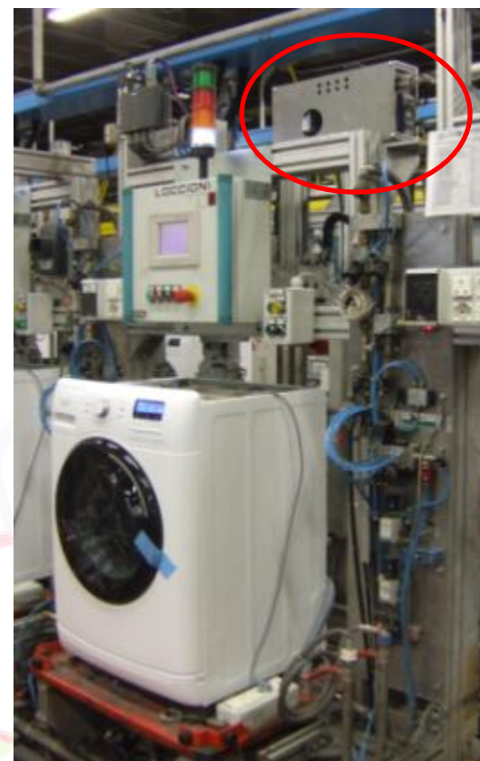
Stazione per il controllo delle vibrazioni emesse dalla lavatrice
