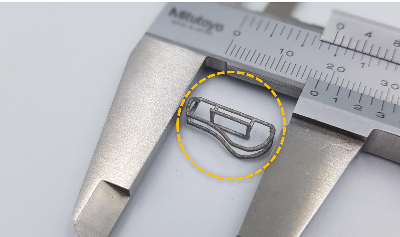
Particolare di piccole dimensioni e sezione 0.7mm
