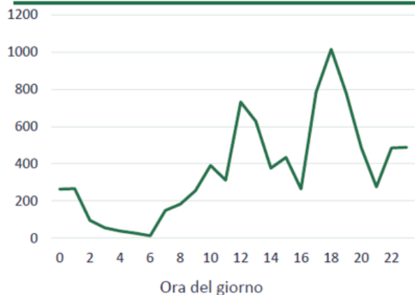
RICARICA NON CONTROLLATA [MW]
