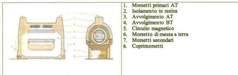
Figura 3 - Sezione di un trasformatore di tensione
