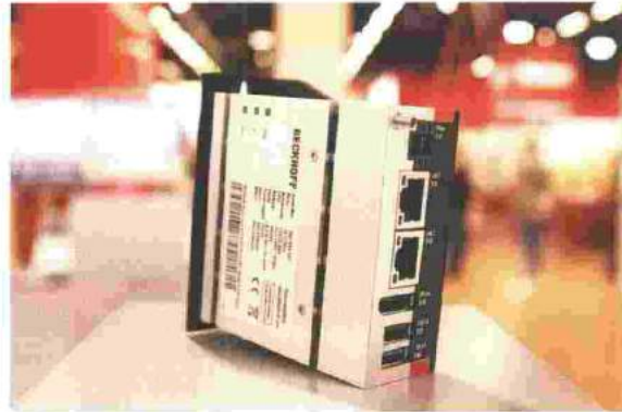
L'IPC ultracompatto C6015: il più piccolo IPC da quadro elettrico.
