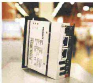
L'IPC ultracompatto C6015: il più piccolo IPC da quadro elettrico.
