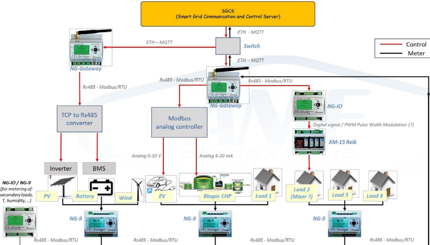
Schema del sistema di acquisizione e controllo della smart grid
